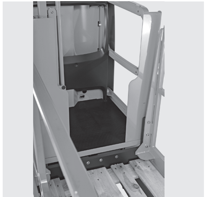
Inserción sencilla y segura en el palet con barreras adicionales en la dirección de la carga
